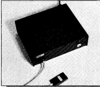
■ DM-2010 SCHNITTSTELLENKONSOLE Wird benötigt als Schnittstelle zu Steuergerät für die unabhängige Programmierung und unabhängige Berechnung der Laufzeit. Wird ausserdem zum Betrieb des Druckers und der Digitalkassettenstation gebraucht.
